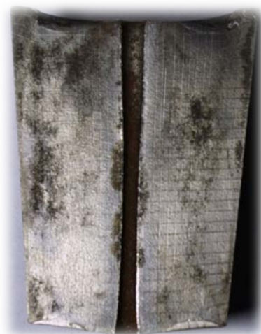
Рисунок 3 – Эскиз заготовки (а), полуфабрикат (б) после радиального обжатия
